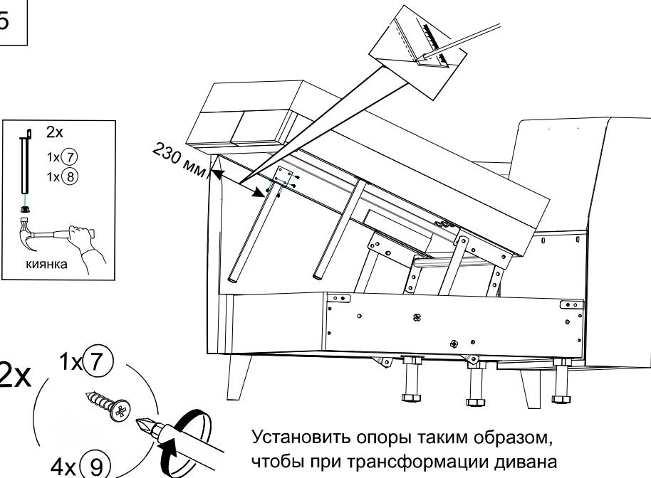
Установить опоры таким образом, чтобы при трансформации дивана они не задевали за переднюю царгу
